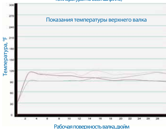
График профиля температур (весь валок показан как одна дорожка записи на приборе для измерения профиля температуры по всей ширине)
