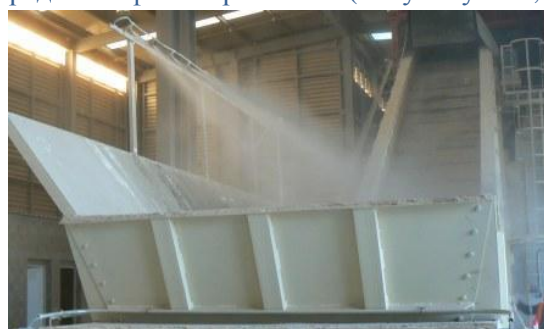
Рис.7: Распылитель, установленный для подавления пыли в воронкообразном бункере с воздушными форсунками серии J
