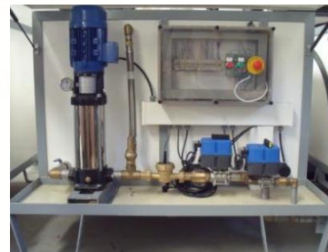
Рис.5: Насосная группа с 1 одноступенчатым насосом
