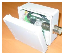
Рис.4: Ультразвуковой датчик (датчик присутствия).
