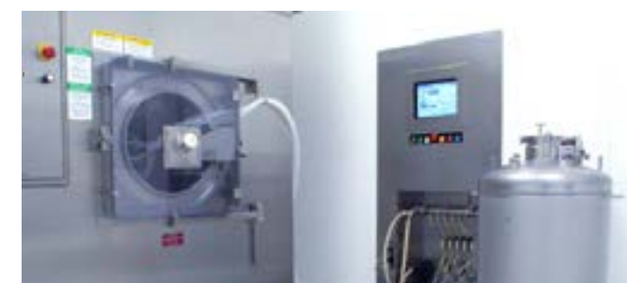
Устройство нанесения покрытий на таблетки, работающее с ПО управления технологическими процессами Batch Architect™
